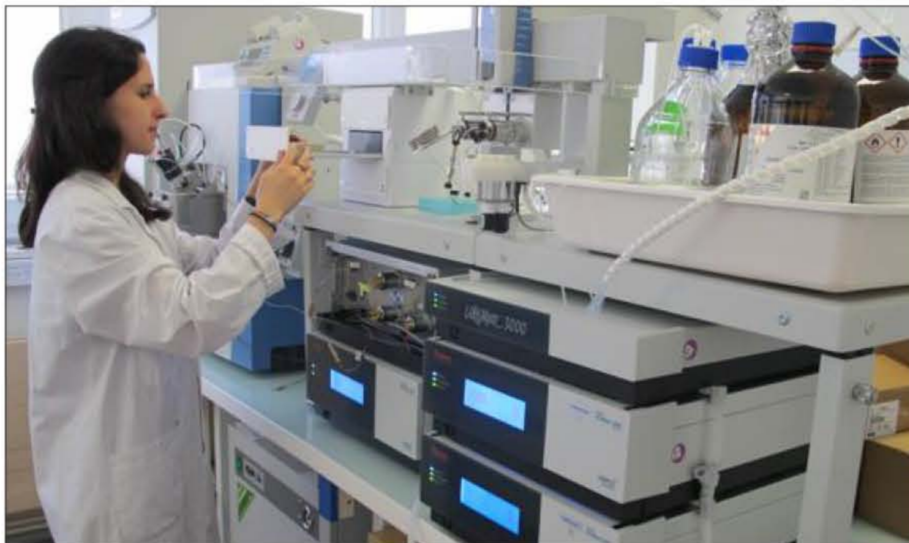
Maïté Sarter, ingénieur d'études, travaille sur la machine d'analyse des micropolluants dans l'eau, qui permet de détecter plus de 800 molécules.
